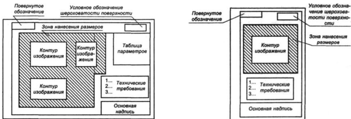
Рисунок - Структура рабочего чертежа
