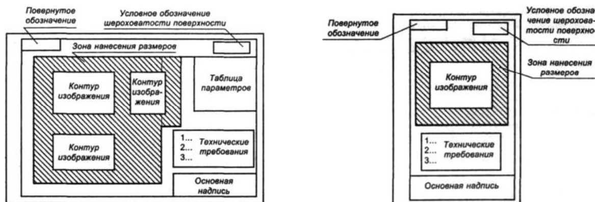
Рисунок - Структура рабочего чертежа
